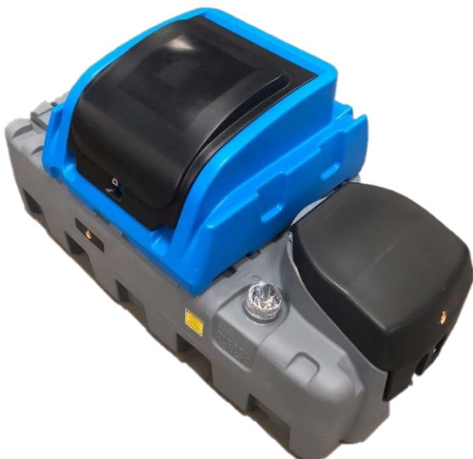
Bi-Réservoir mobile roto-moulé en polyéthylène de capacité 400 litres GO/GNR et 100 litres AdBlue utiles, garanti 2 ans, pour le transport de gasoil , GNR et AdBlue conforme à l'ADR. Il est équipé de brise-flots et de bouchons de remplissage sécurisés par fermeture à clé et de couvercles cadennassables.
