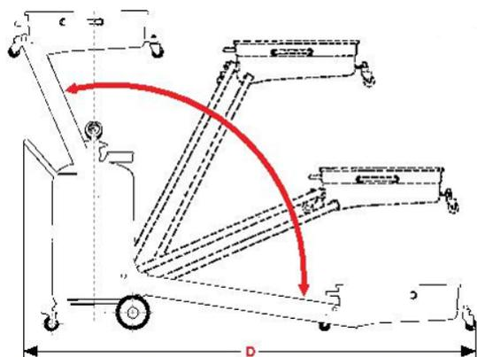
Le bac de récupération peut-être placé au sol ou en hauteur, sous un pont élévateur à l'aide des bras à pantographe
