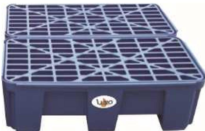
Le bac de rétention 4 fûts en polyéthylène haute densité est inerte aux différents produits chimiques, il est conçu pour une utilisation en intérieur ou en extérieur avec un traitement anti UV. Muni d'un caillebotis plastique, il peut recevoir tous les produits. Grâce à son passage de fourche, il peut être déplacé par transpalette et positionné à la demande. Il peut être multiplié car il est clipsable sur sa longueur et sa largeur.
