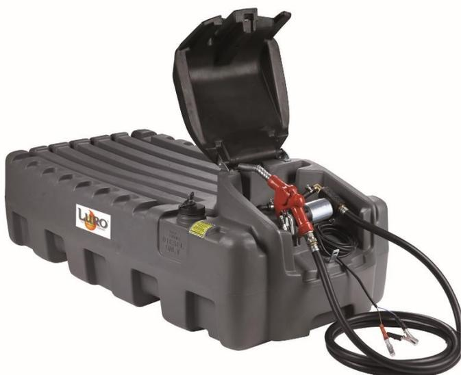
Réservoir mobile roto-moulé en polyéthylène de capacité 400 litres utiles, garanti 2 ans, pour le transport de gasoil conforme à l'ADR. Il est équipé de brise-flots et d'un bouchon de remplissage sécurisé par fermeture à clé et d'un couvercle cadenassable.
