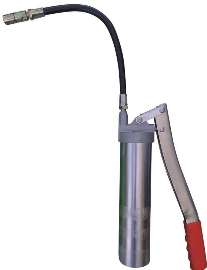
Les pompes à graisse manuelles sont au même titre que la burette et la seringue, un outil incontournable de tous les ateliers, mais peuvent aussi être utilisée à l'extérieur. La pompe manuelle pour cartouches à visser de 400 gr est en acier, équipée d'un flexible caoutchouc avec agrafe 4 coupelles. Pression 400 bar
