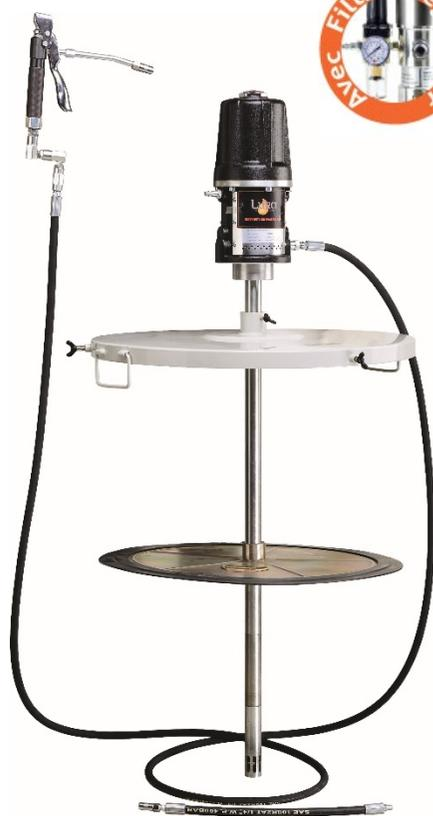
Il est équipé d'une pompe 50/1, d'un couvercle de 600 mm pour fût de 540 à 580 mm, d'un plateau suiveur de 585 mm, d'un flexible de 4m en 3/8" et d'un pistolet avec flexible ou sortie rigide avec agrafe 4 coupelles.
